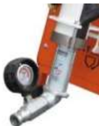
Рис. 22: Манометр давления раствора
