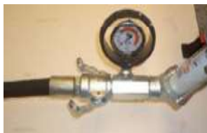
Рис. 73: Манометр давления раствора
