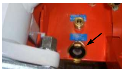
Рис. 79: Сетка для улавливания грязи в водоприемном отверстии
