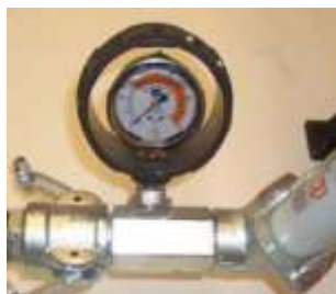
Рис. 36: Манометр для измерения давления материала
