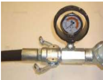
Рис. 76: Давление раствора на „0 бар“
