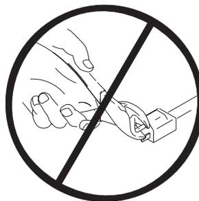
**Удлинители.** Используйте удлинитель с исправным контактом заземления. Если необходим удлинитель, используйте 3-жильный удлинитель калибром не менее 2,5 мм<sup>2</sup> (12 AWG).
